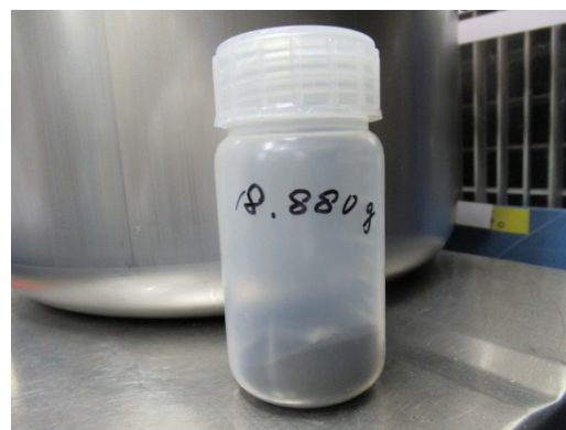
図 7：粉末混合機回転主軸フランジ操作台側で発見した粉末（粉末 B）
