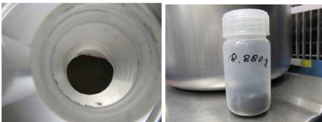
図 7 : 粉末混合機回転主軸フランジ操作台側で発見した粉末（粉末 B）
