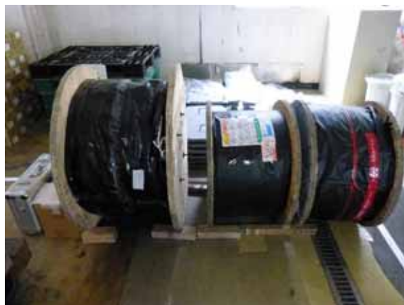
電気ケーブル（仮設用）
