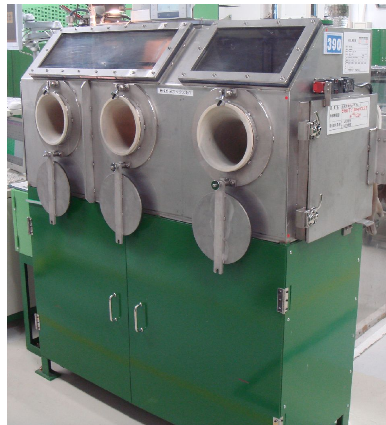
写真 2 粉末作業ボックス No.1 の外観写真
